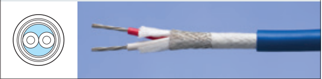
1対丸型ビニル絶縁・ビニルシース 4/0.65 × 1P KX-2-G-J2-IS = VVR
