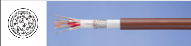
10対丸型ビニル絶縁・ビニルシース 12/0.18 × 10P TX-2-G-J2-IS=VVT
