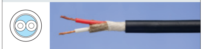
1対丸型シリコンゴム絶縁・クロロプレンゴムシース 40/0.2 × 1P RX-SRNR=KNR
