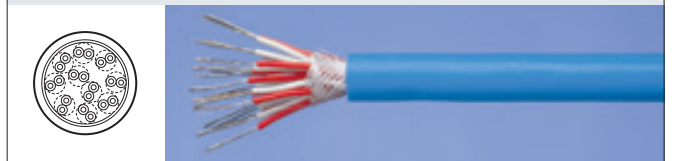
10対丸型シリコンゴム絶縁・シリコンゴムシース 30/0.1 × 10P KX-2-SR-J2=KKT/C
