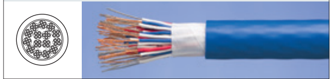
30対丸型ビニル絶縁・ビニルシース 7/0.3 × 30P(4C/15B) KCB(VX)-2-G-J2=VVT
