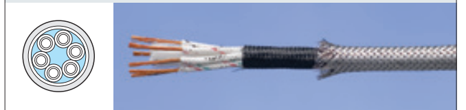
3対丸型ガラス絶縁・ガラス編組被覆 7/0.3 × 6C(3P) RCB-2-H-J2-SOS=GBR
