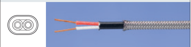
1対平型ガラス絶縁・ガラス編組被覆 7/0.3 × 1P RCB-2-H-J2-SOS
